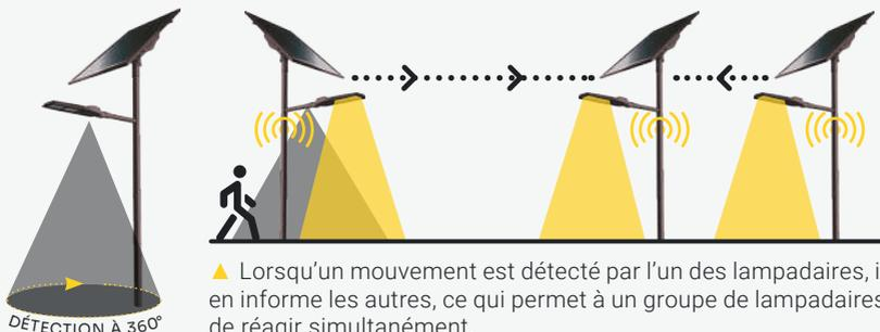
▲ Lorsqu'un mouvement est détecté par l'un des lampadaires, il en informe les autres, ce qui permet à un groupe de lampadaires de réagir simultanément.
